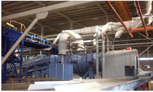
Sarsak hatları ve toz toplama sistemi
